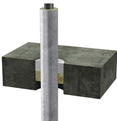
Figur 3. Tjocklek GPG 50 mm. Genomgående rörisolering 30 mm tjock, 550 mm längs vardera sidan av plattan
