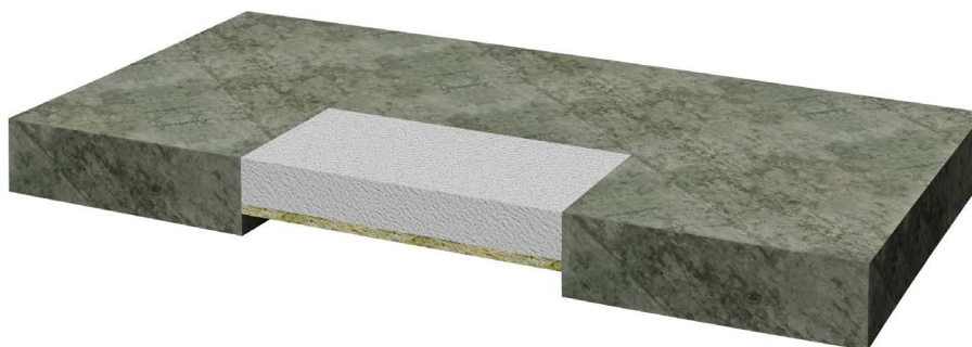
Figur 3. Tjocklek GPG 80 mm. Fyllning av 20 mm stenull, densitet 150 kg/m 3
