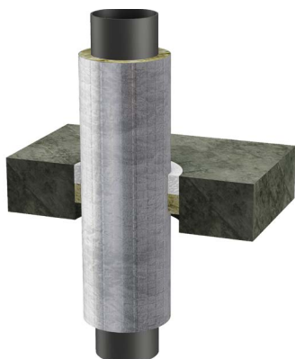
Figur 3. Tjocklek GPG 50 mm. Genomgående rörisolering 30 mm tjock, 550 mm längs vardera sidan av plattan
