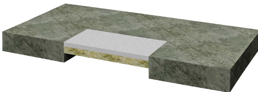
Figur 2. Tjocklek GPG 50 mm. Fyllning av 20 mm stenull, densitet 150 kg/m 3
